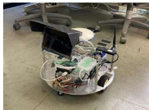
図3 RTK 高精度位置情報を利用した走行制御実験に用いる機体
