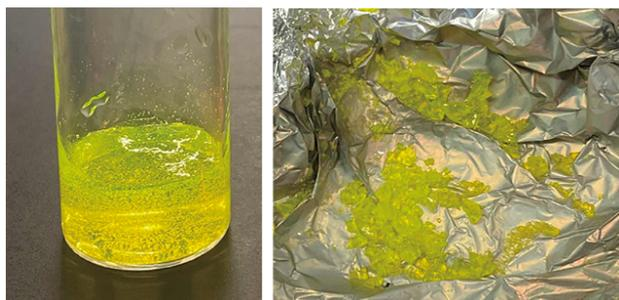
図 3-2 フルオレセインを含むゲル化直後のシリカゲル (左), アルミ箔上で 150 °C, 15 分間乾燥後のシリカゲル (右)
