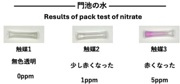
Fig. 4 触媒反応後のパックテストによる門池の水中の硝酸イオン濃度の結果
