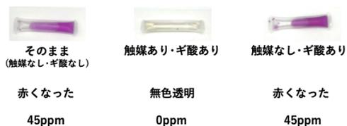
Fig. 6 触媒反応後のパックテストによる結果
