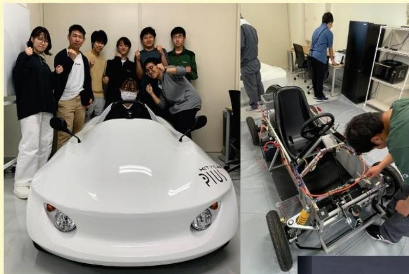
沼津高専に改造が容易な組み立て分解型の電気自動車(EV)「PIUS」がやってきました。定格出力0.6 kWの直流モーターと容量38Ah、36Vのバッテリーを積んでいます。現在E科学生9名のメンバーで、PIUSプロジェクトをおこなっています。まずはEVの仕組みを学ぶために、37工程の分解作業と、41工程の組み立て作業を行い、機械系、電装系を理解しました。組み立て時には各パーツで決まっている締め付けトルクどおりに締め付けるので、初回は非常に慎重に作業を行い、4時間ほどの時間を要しました。
