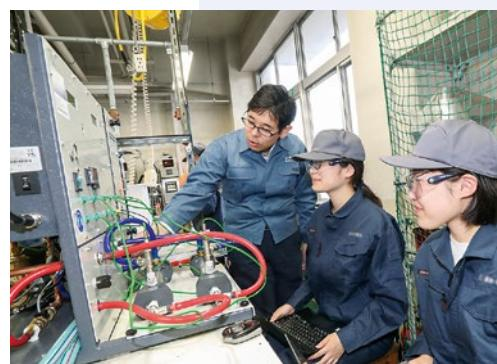
4年 化学工学実験（二重管式熱交換器）
