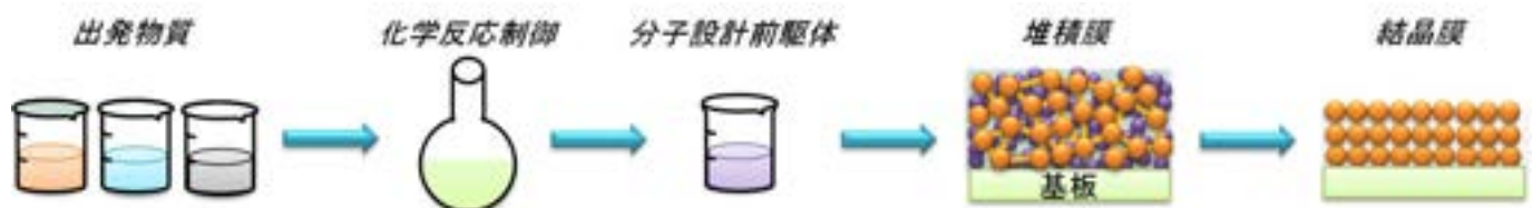
図 1. 溶液法プロセス
