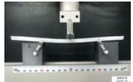
Mode I および Mode II 荷重下における破壊試験
