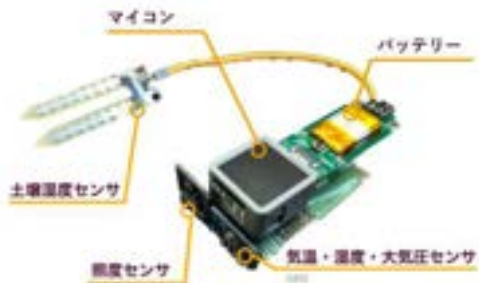
植物生育環境のモニタリングのためのエッジデバイス
