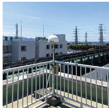
図1. GNSS連続観測点 [沼津高専屋上局]
