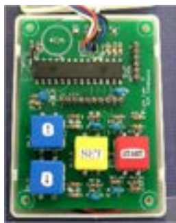
「酸素ポンベの残量計の試作」 残量計の外観と製作した基板
