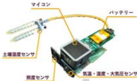
植物生育環境のモニタリングのためのエッジデバイス
