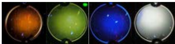
石英ガラスにドーピングする元素を変えた場合の発光例
