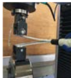
Mode I および Mode II 荷重下における破壊試験
