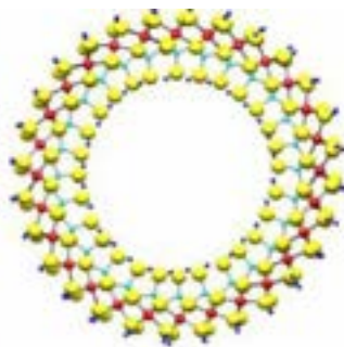
アルミノゲルマネートナノチューブの構造モデル
