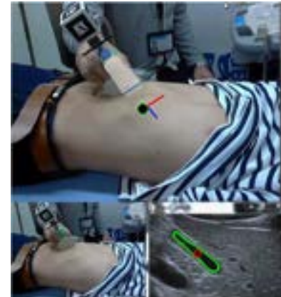
断層像処理による臓器形状・位置の推定
