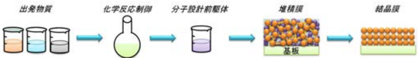
図1.溶液法プロセス
