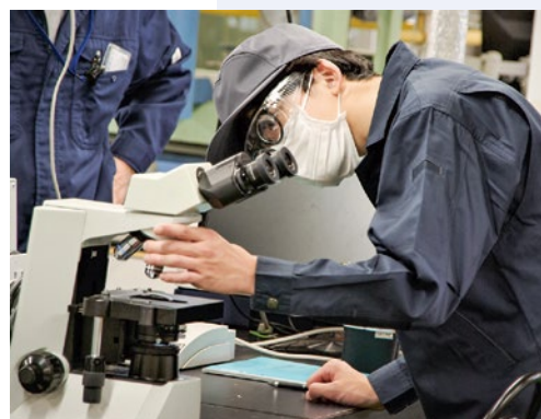
4年 化学工学実験 (酵母の増殖速度測定)
