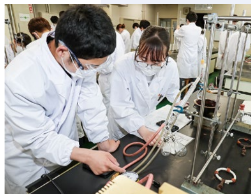
3年 有機化学実験 (減圧蒸留)
