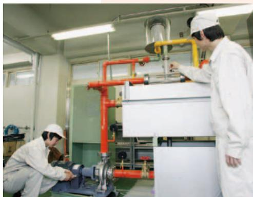
5年 機械工学実験（渦巻ポンプの性能試験）
