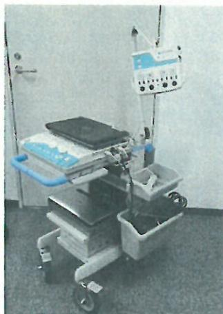
筋電図・誘発電位検査装置
