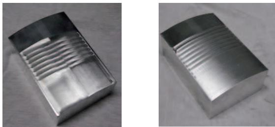
図7 凸型円弧曲面走査線X方向加工
