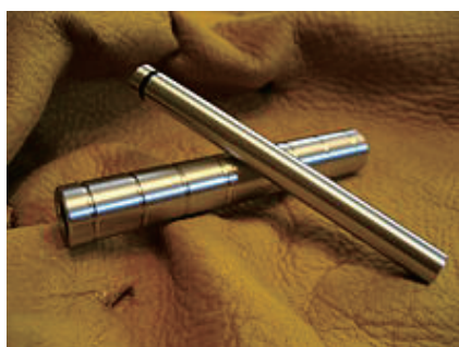
Fig.6 圧気発火器 (登山用の発火器) [2] .
