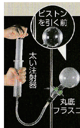
Fig.3 断熱膨張による水蒸気の凝縮 [3]
