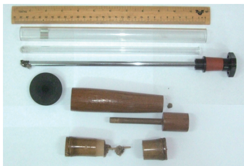
Fig.4 圧気発火器 (島津理化製, 上側) と圧気発火器 (オランダスリによるマレーシア産, 下側).
