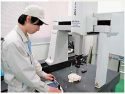
三次元測定機による計測
