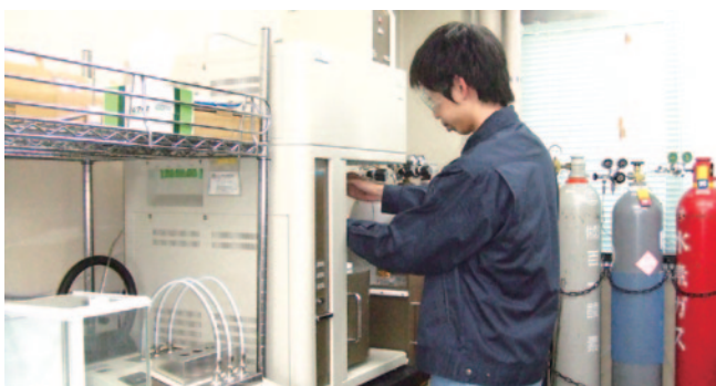
5年 卒業研究（機能材料の細孔分布測定）
