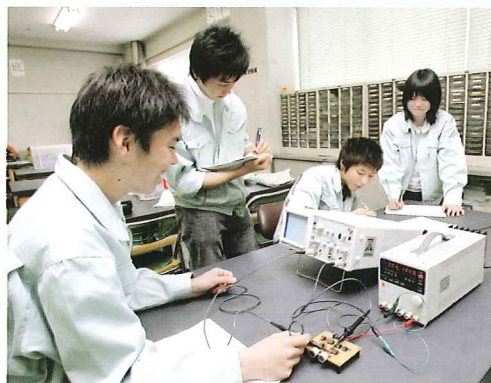
3年工学実験 (超音波による距離計測)
