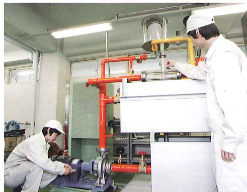
機械工学実験（渦巻ポンプの性能試験）
