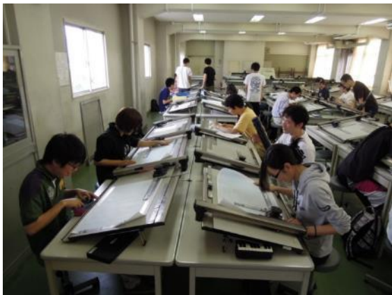
ドラフターを使用した設計製図
