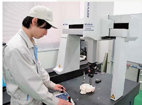
三次元測定機による計測
