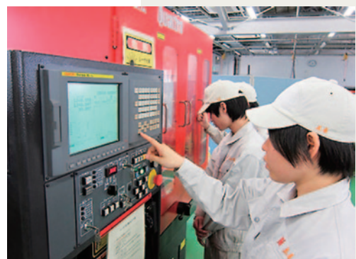
レーザー加工機による実験装置製作
