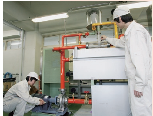
機械工学実験（渦巻ポンプの性能試験）
