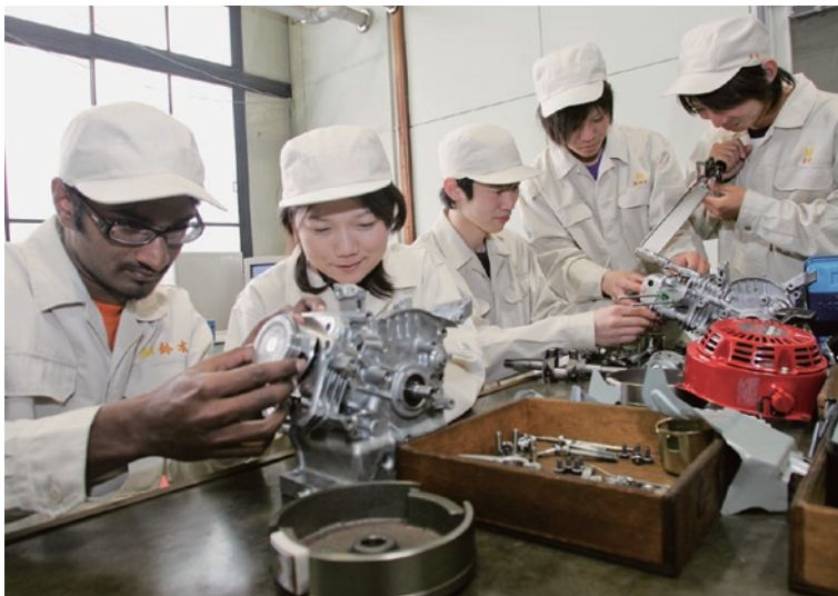
機械工作実習（エンジンの分解・組立て）
